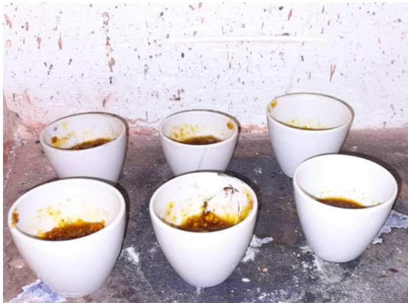
Figura 7. Muestras dentro de la mufla.
