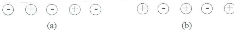
Figura 1.2 Defectos en la red de un cristal iónico: (a) defecto Schottky y (b) defecto Frenkel. Cada uno de estos dos tipos de defectos son representados por un par de imperfecciones.
