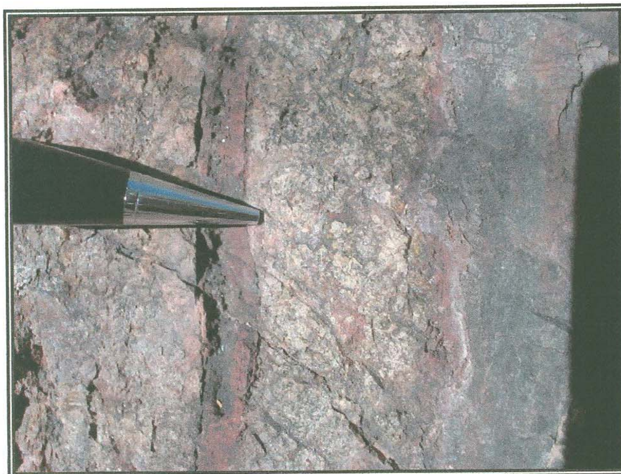
Foto 24.- Fotografía que muestra una vetilla de magnetita dentro de los horizontes calcáreos recristalizados.
