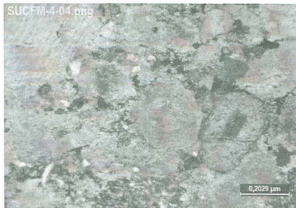
Figura 32 – Grainstone con bioclastos cubiertos por cementante de esparita.
