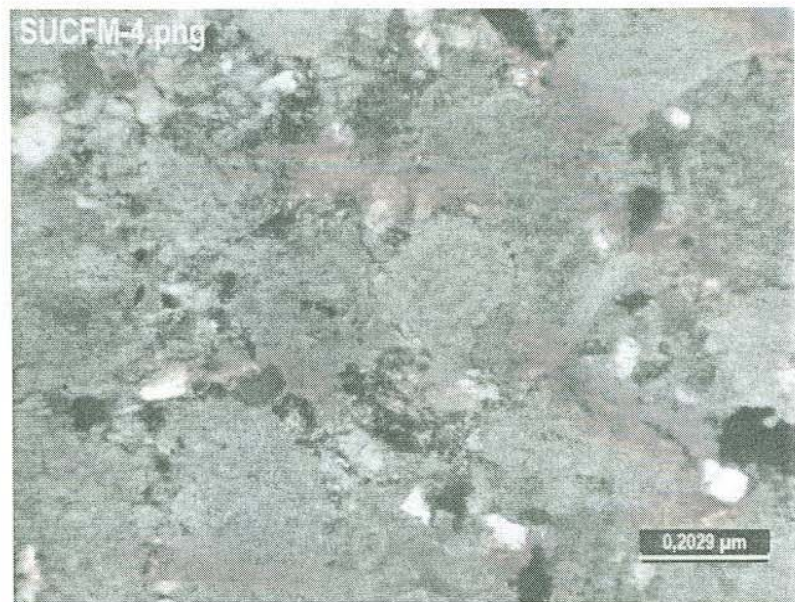
Figura 14 – Bioesparita, se observa fósiles foraminíferos (fusulinidos), placas de crinoideos, intraclastos y aporte terrígeno (cuarzo monocristalino), cementante de óxido de hierro.
