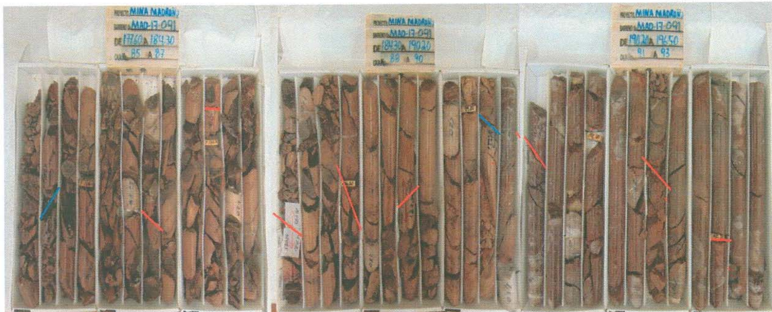
Figura 14.- Cajas de núcleos con sus respectivos contactos. Las líneas azules representan fallas y las rojas contactos.
