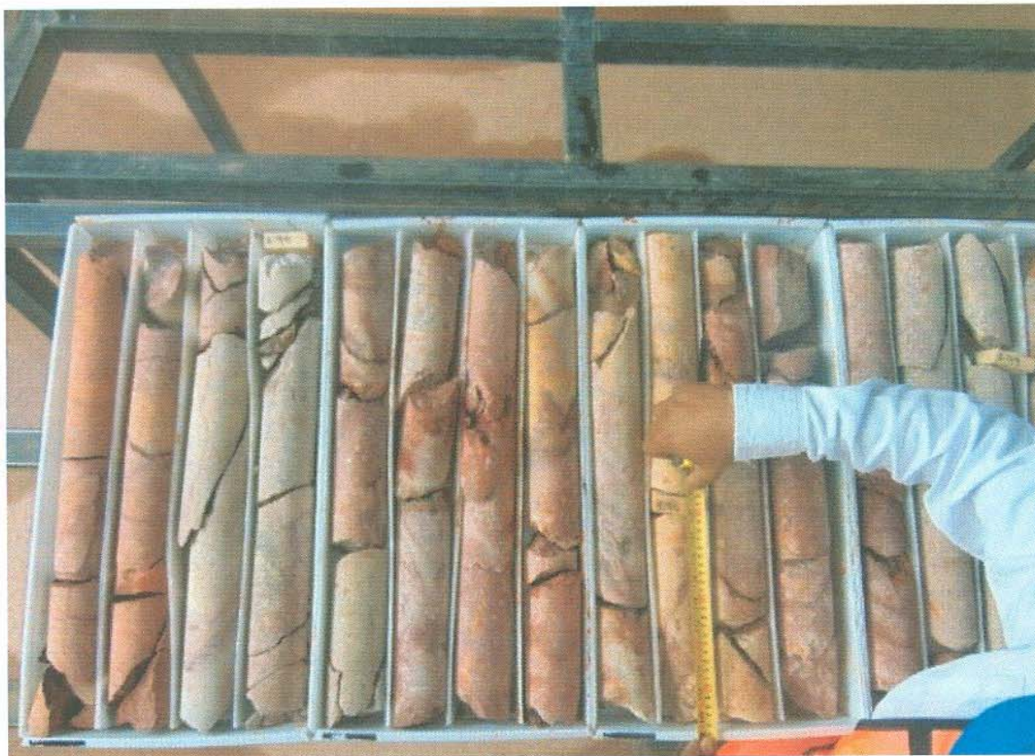
Figura 10.- Al generar la barrenación se perforan intervalos de 3 m, y no todo el tiempo se recuperan esos 3 m. Por ese motivo se calcula el porcentaje de recuperación del núcleo.
