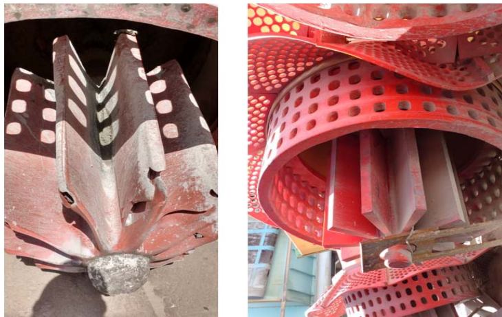
Figura 17. Comparación del antes y el después de una pieza mecánica para las celdas WEMCO.
