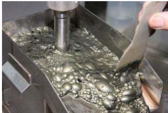
Figura 3. Celda de flotación para la separación de minerales.
