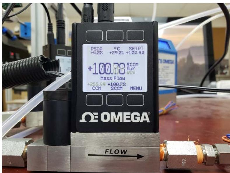
Ilustración 20) Caudalímetro del canal B en 100 sccm
