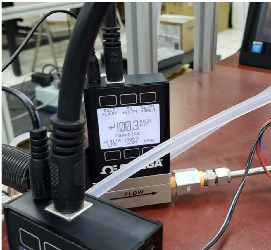
Ilustración 22) Caudalímetro del canal A en 400 sccm
