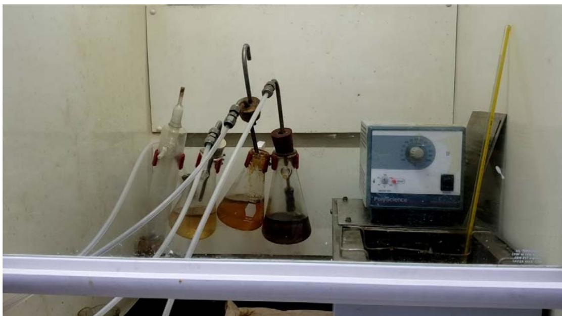
Ilustración 21) Burbujeo de nitrógeno.
