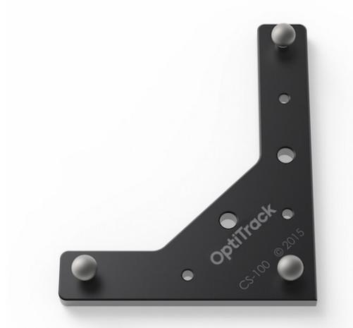
Figura 2.10: Escuadra de calibración usada para establecer el origen del sistema coordenado.
