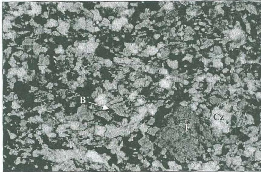
Figura 6. Fotomicrografía de la muestra 14, que corresponde a una filita. Constituida principalmente por cuarzo (Cz), biotita (B) y feldespato (F), con abundantes minerales opacos. La biotita se encuentra parcialmente cloritizada, con ligera deformación en los cristales de cuarzo y la mineralogía en general orientada, constituyendo la foliación presente en esta unidad. LP-10x.
