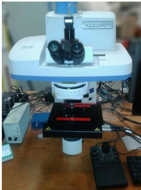
Figura 3.4 Espectrómetro MicroRaman Horiba Jobin Yvon
