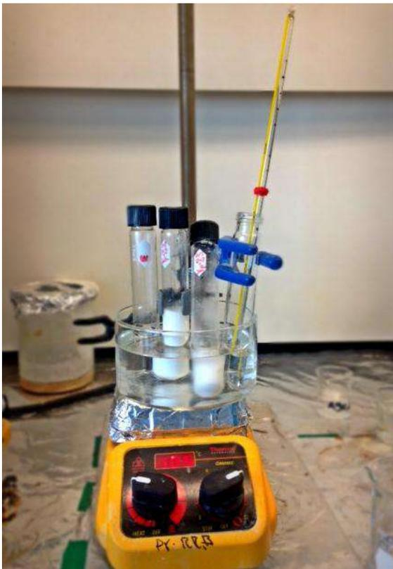
Figura 28. Baño químico de las muestras YP-Z con temperatura y agitación.
