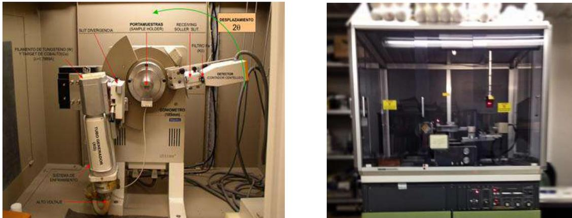
Figura 39. Equipos de DRX utilizados, en la parte izquierda se observa el del Cinvestav mientras que a la derecha está el de la Unison.
