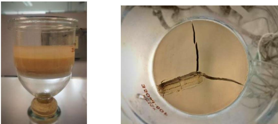
Figura 31. *Izquierda: proceso de filtrado al vacío de la CHA con agua desionizada. Derecha: producto semihúmedo de CHA después de la filtración.*
