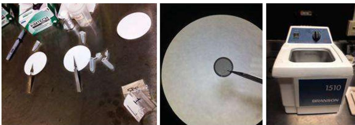
Figura 45. Procesos previos al análisis, en la izquierda se visualiza como en las pinzas se sostienen las rejillas esperando a que se evapore el líquido dispersivo; en la imagen central es la vista de la rejilla en un microscopio y en la imagen diestra se visualiza el dispersor ultrasónico.
