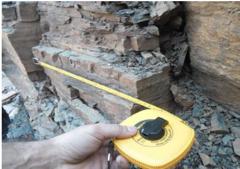
Figura 5. Medición del espaciamiento entre fracturas pertenecientes al mismo tipo de familia. En el sitio mina La Pizarrina.
