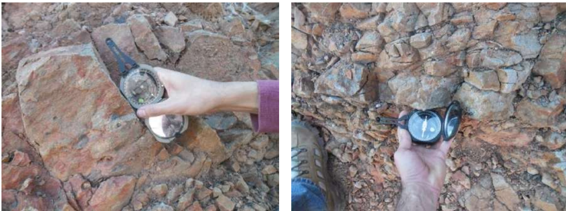
Figura 4. Medición de rumbo y echado en fracturas del sitio mina Margarito Gracia.
