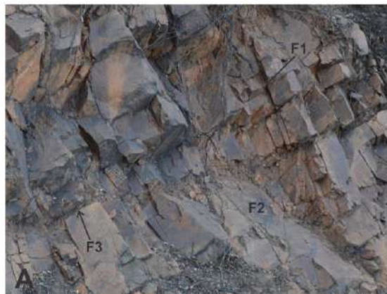
Figura 19. Segmento 3 del sitio El Refugio se muestra la litología dominada por areniscas y las diferentes familias de discontinuidades en este sitio (A).
