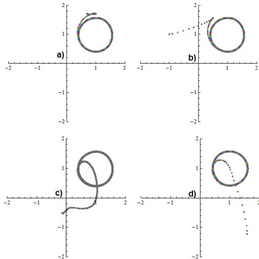
Figura 4.12: Trayectoria seguida por el segundo eslabón del brazo mecánico
