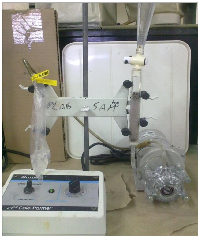
Figura 13.- Prototipo para la desinfección de agua por medio del filtro.
