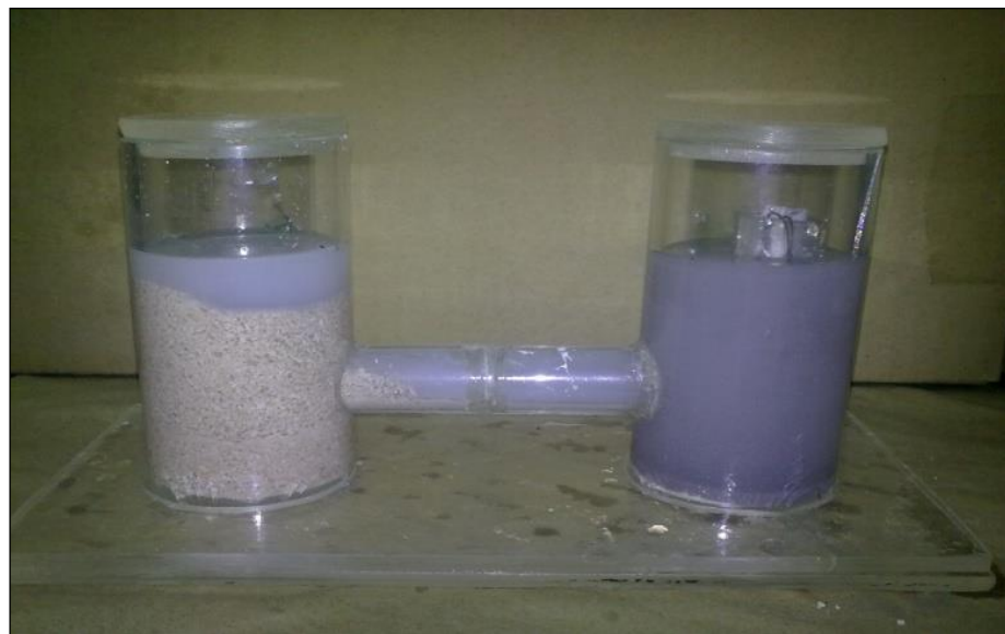
Figura 7.- Proceso separado del zinc y la zeolita activada en solución de nitrato de potasio
