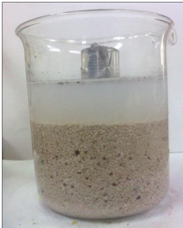
Figura 5.- Contacto directo del zinc con la zeolita activada en solución de nitrato de potasio.
