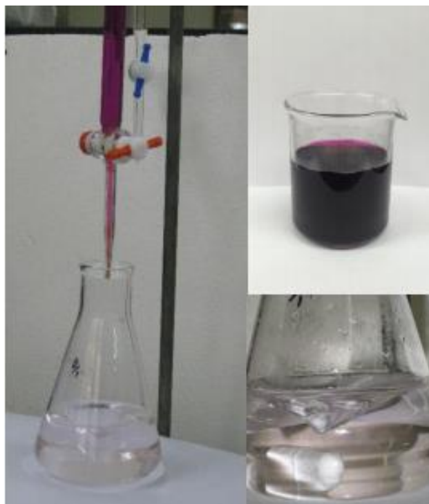
Figura 12. Análisis para la determinación de ion ferroso.
