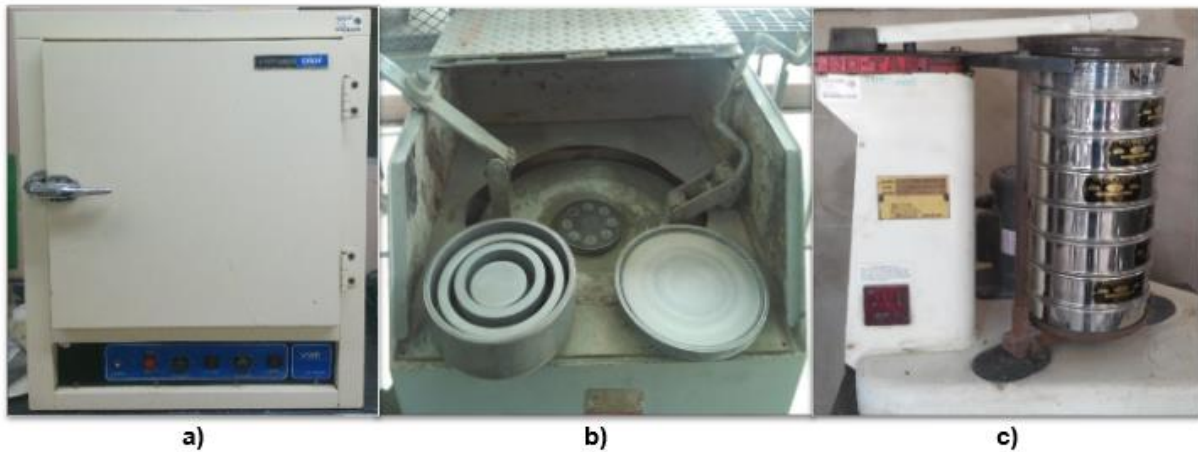
Figura 5. a) Secador de convección, b) Pulverizador de anillos y c) Ro-tap (cribado)
