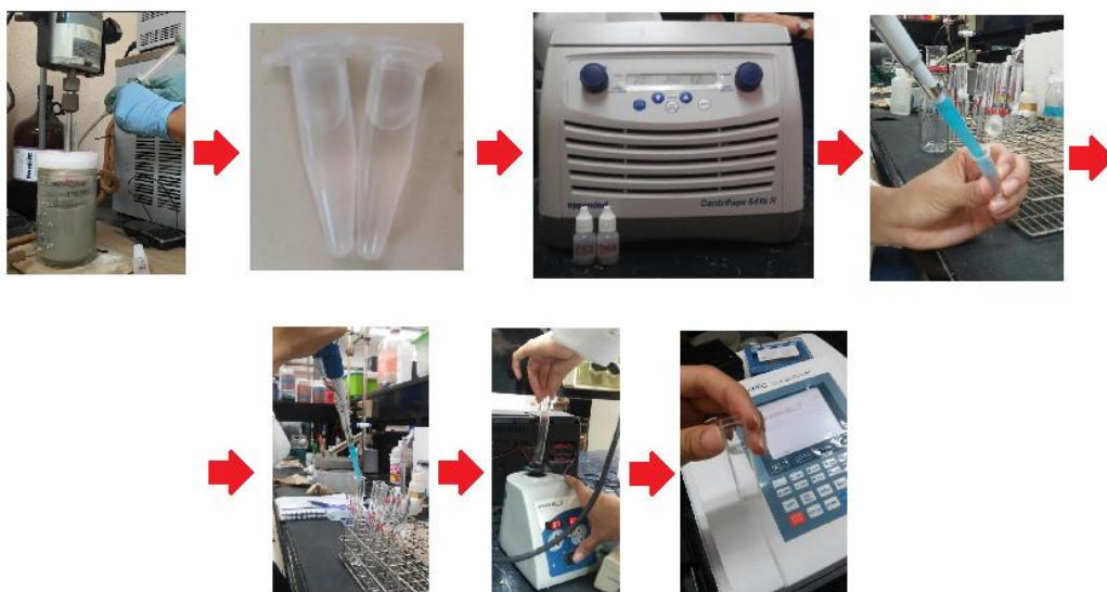
Figura 11. Diagrama para la determinación de ion férrico.
