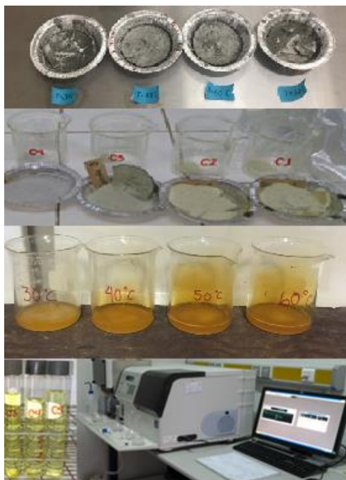
Figura 8. Digestión de muestras sólidas y análisis de contenido de Hierro y Cobre
