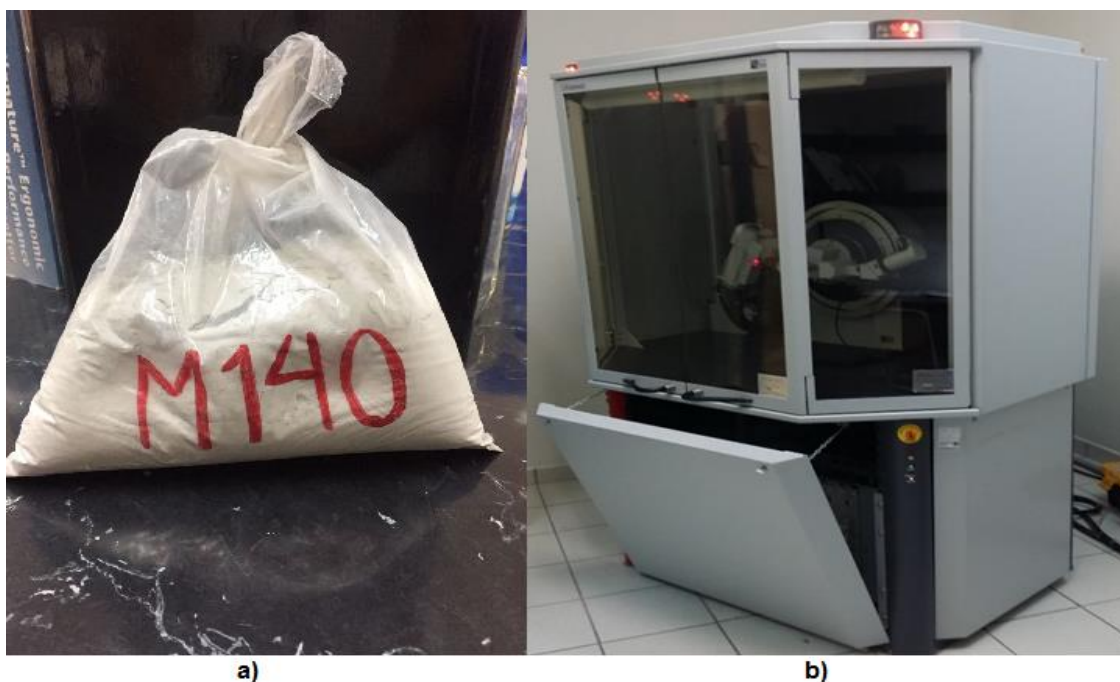
Figura 7. a) Colas de flotación (+100-140) b) Difractómetro de Rayos X para polvos.
