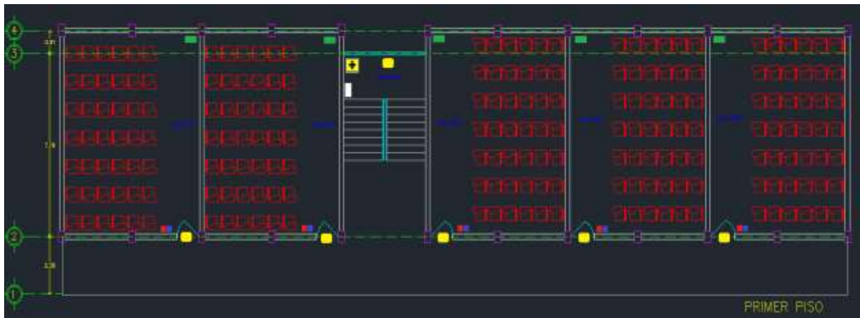
Figura 46. Representación de la distribución de los dispositivos de la primera planta.
