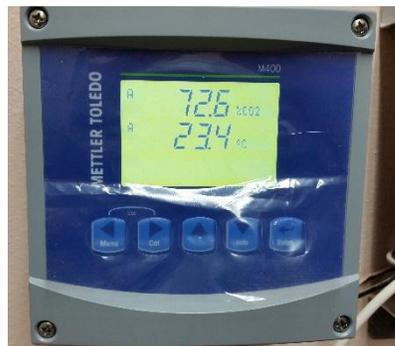
**Figura 8.** Transmisor M400 muestra la concentración de  $\text{CO}_2$  en el agua en distintas unidades (se requiere el uso del InPro 5000 sensor de  $\text{CO}_2$ ).
