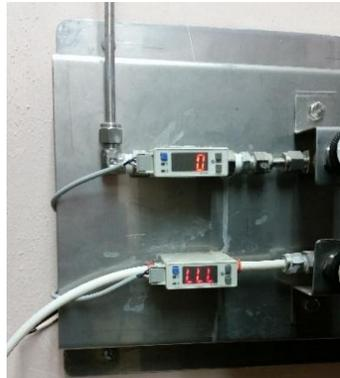
**Figura 3.** Medidores de flujos de los gases aire y CO<sub>2</sub>.
