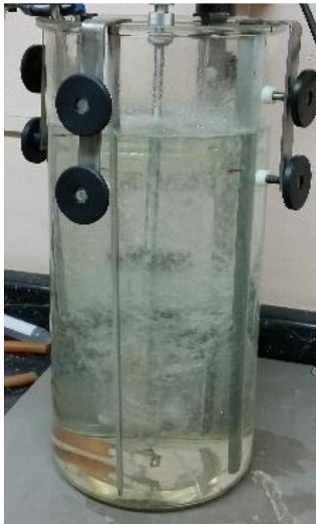
**Figura 10.** Muestra el sistema totalmente conectado, agitación encendida (con suministro de gas).
