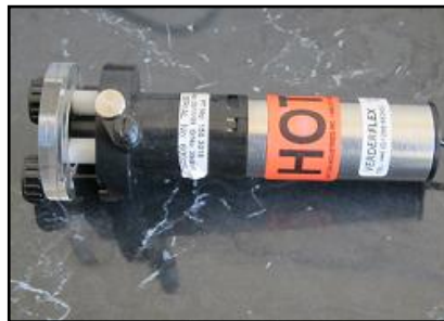
Figura 35. Bomba peristáltica de 24 volts DC de una sola velocidad.
