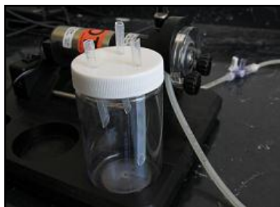
Figura 41. Tanque de 120 mL para la solución de alimentación.
