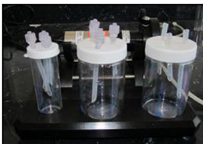
Figura 43. Tanque de 30 mL para solución de filtrado, Tanques de 120 mL para solución de lavado y alimentación.
