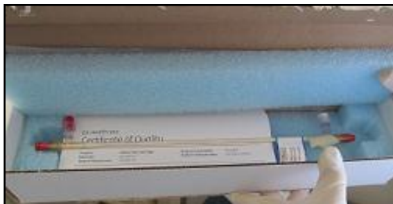
Figura 44. Membrana de fibra hueca para el sistema de ultrafiltración tangencial.
