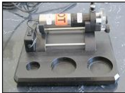
Figura 36. Plataforma de montaje y bomba peristáltica.
