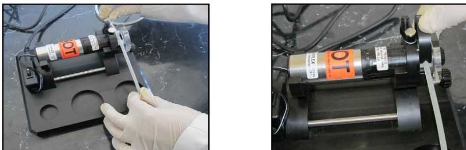
Figura 40. Ajuste de la manguera de alimentación en la bomba peristáltica.
