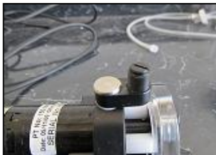
Figura 37. Perilla para ajustar la velocidad de flujo de alimentación al sistema.
