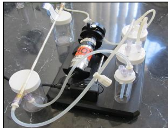
Figura 12. Sistema de ultrafiltración con flujo tangencial MidJet Benchtop System, GE.
