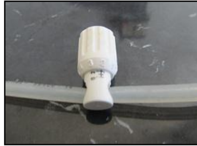
Figura 46. Válvula de retención o contrapresión en la línea de retroalimentación.
