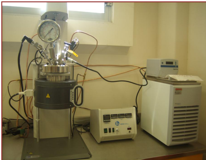
Figura 11. Reactor de Acero Inoxidable marca Parr
