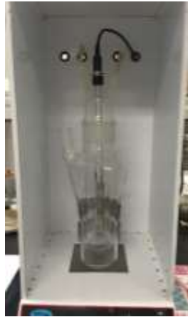
Figura III.2. Reactor para realizar la degradación de colorantes.
