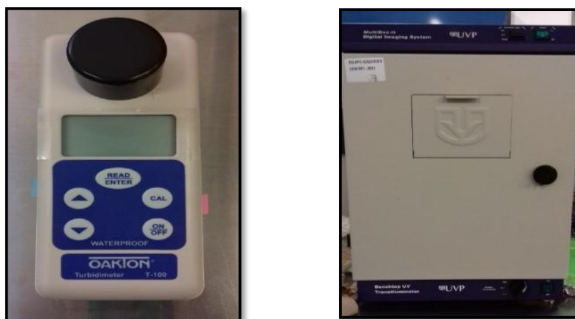
Figura 13. Equipos de medición de turbidez y cámara. a) Turbidímetro Oakton. b) MultiDoc Digital Imaging System
